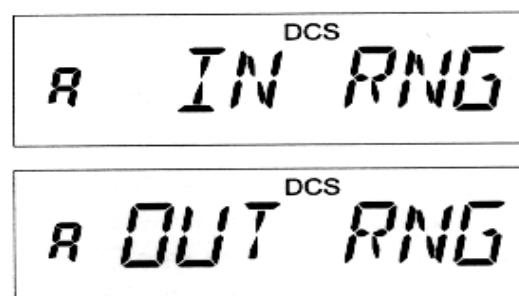
Если Вы вышли из зоны связи более чем на одну минуту, то прозвучат три коротких сигнала и на экране появится титр «OUT RNG». В режиме автоматического оповещения на экране не показан номер канала и не могут быть изменены какие-либо установки.
