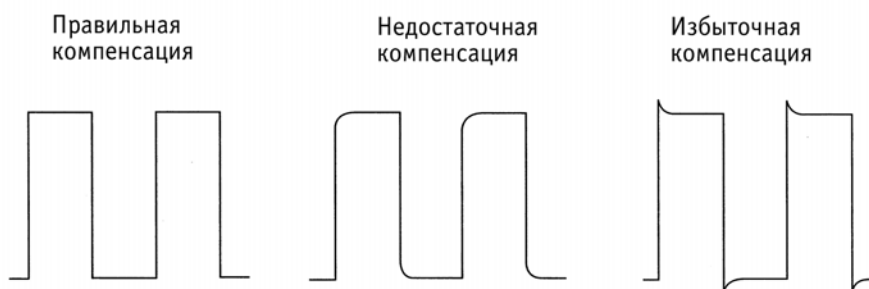
(b) ВЛИЯНИЕ КОМПЕНСАЦИИ ПРОБНИКА НА ИЗОБРАЖЕНИЕ СИГНАЛА МЕАНДРА
