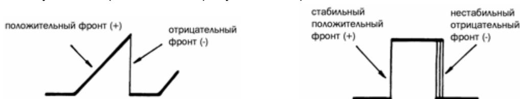
Рис. 2-4. Выбор полярности синхронизации
