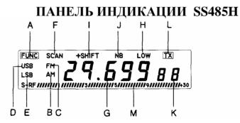
**A) Function Mode :** Индикация включения кнопки "Func" и включения режима программирования
