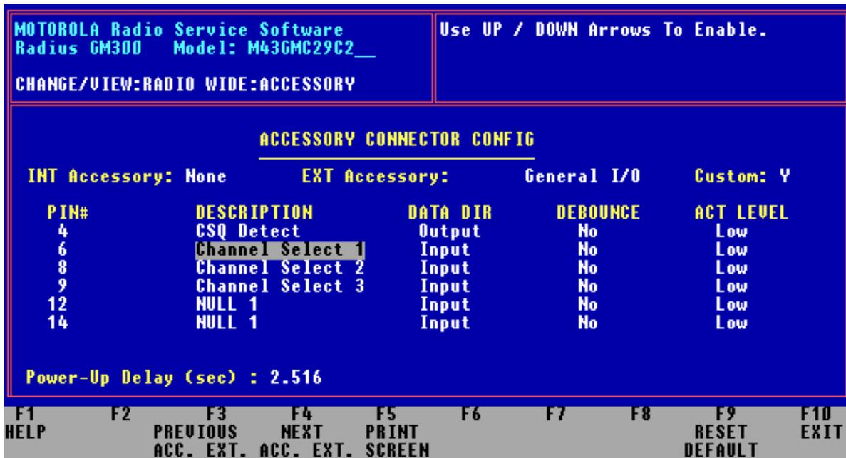
Рис. 7 Конфигурация контактов разъёма аксессуаров для радиостанции GM300 (16 каналов)
