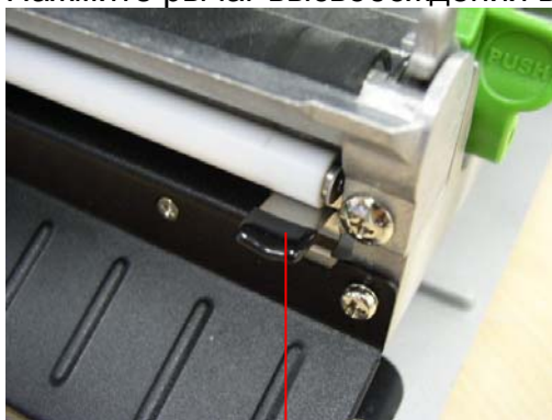
Рычаг высвобождения валика снятия защитной пленки
