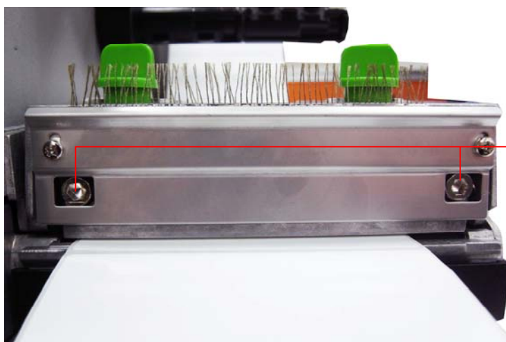
Ручки для регулировки линии нагрева печатающей головки
