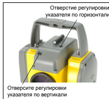
Юстировочные отверстия лазерного указателя
