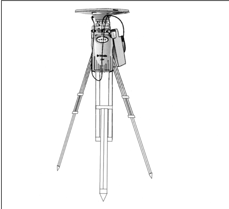
Рис. 7.1 Установка приемника для Статики или Быстрой Статики
