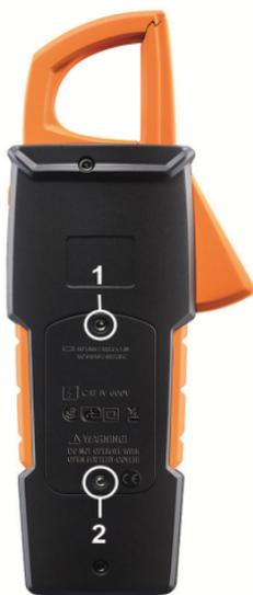
2. С помощью отвертки открутите два металлических винта (7, 8) на отсеке для батареи и снимите крышку отсека. Не извлекайте винты полностью. Using a screwdriver, unscrew the two metal screws (1, 2) on the battery compartment until the battery compartment cover can be removed. Do not unscrew the screws completely.
