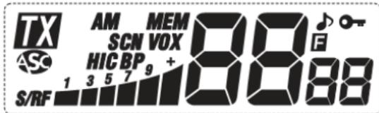
Индикатор отображает номер канала, включённые функции, уровень приема и уровень выходной мощности.
