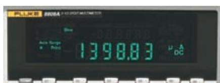
В Fluke 8808A предусмотрены два диапазона с малым входным сопротивлением для измерения малых токов утечки
