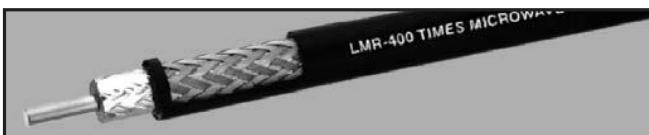
**• Гибкий:** С минимальным радиусом изгиба 1 дюйм, кабель LMR-400 может быть легко проложен в труднодоступных местах без образования изломов. Использование наружного экрана из алюминиевой ленты обеспечивает великолепную гибкость LMR по сравнению с кабелями, экранированными гофрированным или гладким медным листом.
