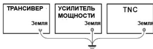
ПРАВИЛЬНОЕ ПОДКЛЮЧЕНИЕ ЗАЗЕМЛЕНИЯ
