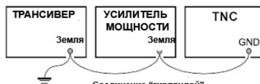
НЕПРАВИЛЬНОЕ ПОДКЛЮЧЕНИЕ ЗАЗЕМЛЕНИЯ
