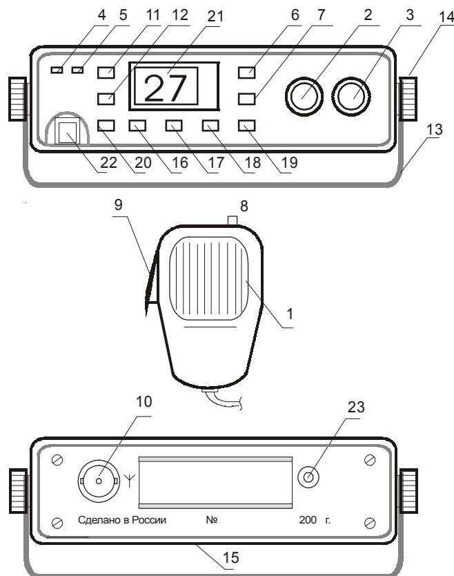
6. Кнопка “С“ включения режима установки сеток частот.
