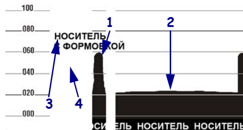
Рис. 20 • Профиль датчика (участок носителя)
