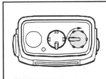
□ Выберите необходимый Вам канал с помощью ручки селектора каналов **CH** на верхней панели радиостанции.
