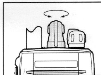
□ Вращением ручки **VOL/PWR** установите желаемый уровень громкости. Если сигнал отсутствует, нажмите и удерживайте кнопку **МОНИТОР** в течение 1 секунды (нижняя кнопка на левой стороне). При этом будет слышен собственный шум приемника, что позволит Вам установить желаемый уровень громкости.
