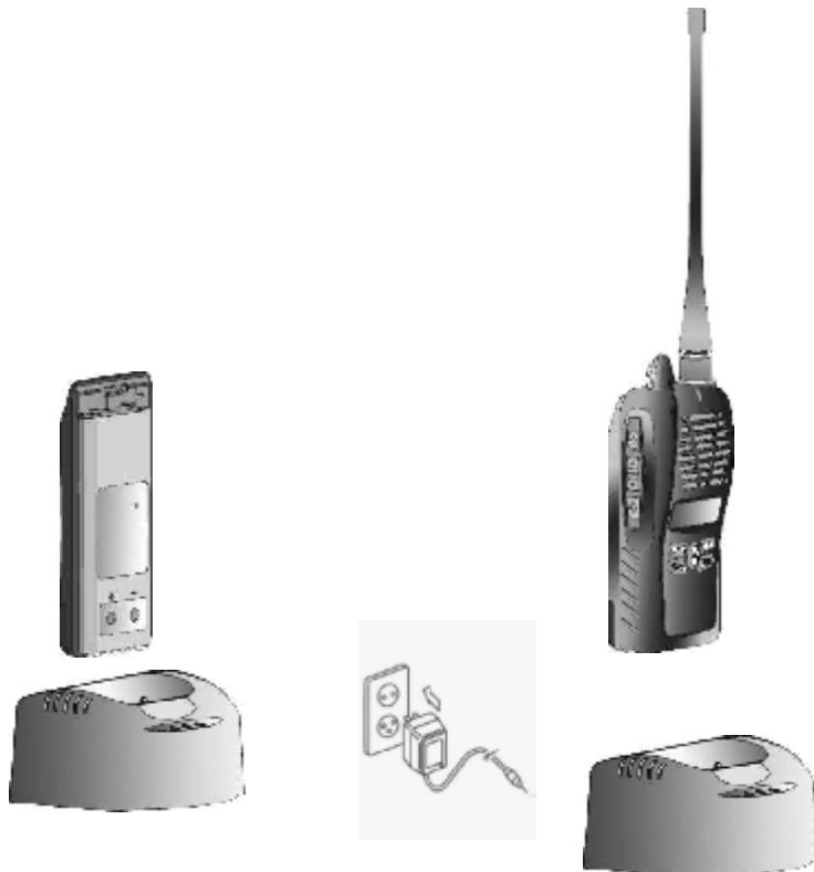
Заряд аккумуляторной батареи производят через зарядное устройство двумя способами:
