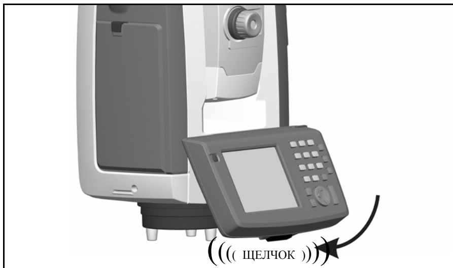
Рис. 4.40. Установка контроллера Trimble CU
