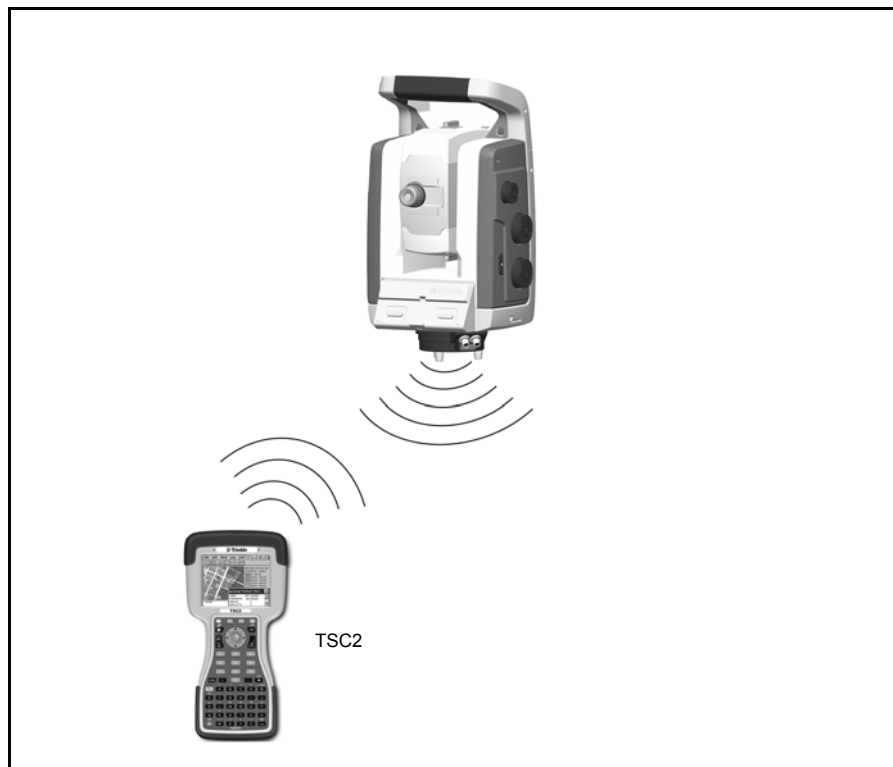
Рис. 4.44. TSC2 подключается к тахеометру Trimble серии S с помощью интерфейса беспроводной связи Bluetooth для измерений в режимах Servo и Autolock.
