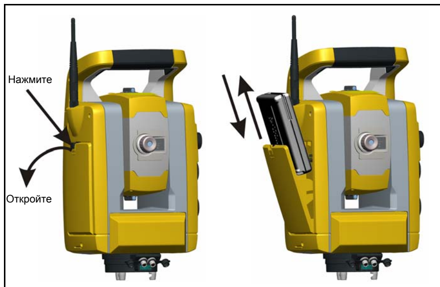
Рис. 3.5. Извлечение и замена внутренней батареи
