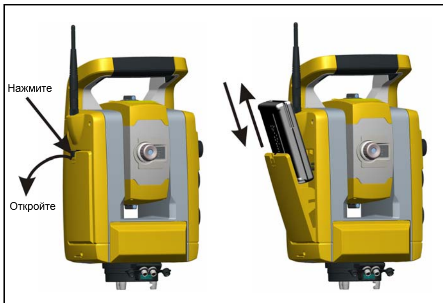
Рис. 5.34. Извлечение и замена внутренней батареи
