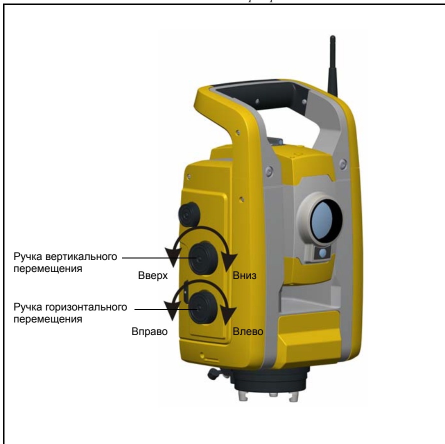
Рис. 5.32. Сервопривод позиционирования
