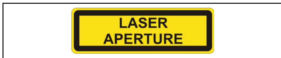
Рис. 3.16. Предупреждающая наклейка об апертуре лазера
