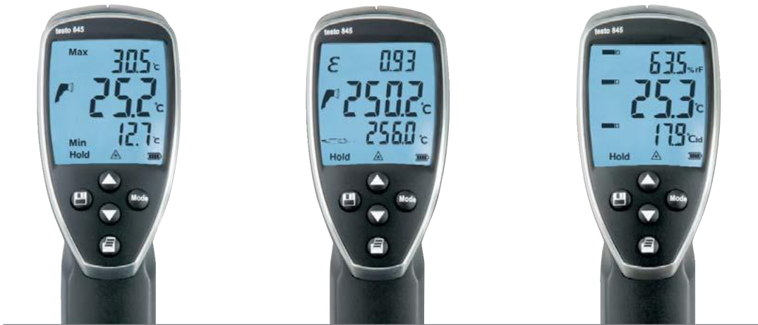
Вид дисплея во время инфракрасных измерений: текущее значение, мин./макс. значения
