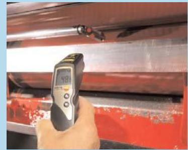
Надежность измерений благодаря лазерному целеуказателю
