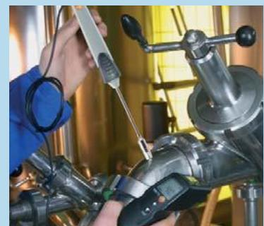
Подсоединение дополнительных зондов температуры (testo 830-T2/T3/T4;)
