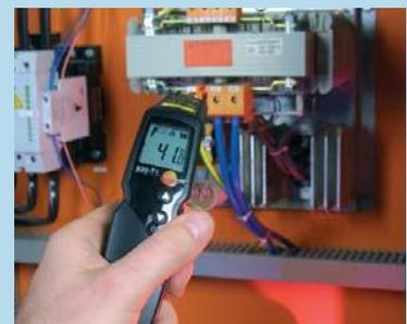
Измерительная точка диаметром 2 мм (testo 830-T3)
