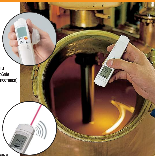
Сканирующие тесты температуры во время расфасовки жидкого шоколада
