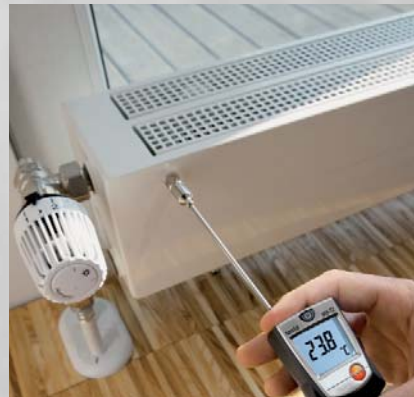
Измерения поверхностной температуры радиатора
