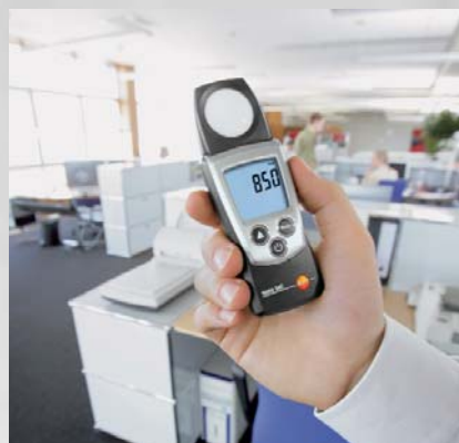
Измерение интенсивности освещенности на рабочих местах
