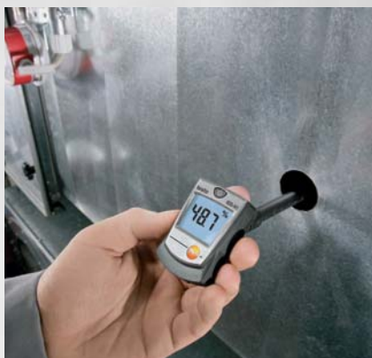
Мониторинг влажности воздуха в воздуховоде
