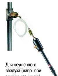
Для осущенного воздуха (напр. при осушке гранулята), необходим телефонный шланг и камера для измерений, клапан камеры полностью открыт
