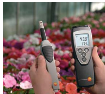
Наконечник зонда влажности подсоединяется к рукоятке радио зонда, для мониторинга на соответствие климатических нормам
