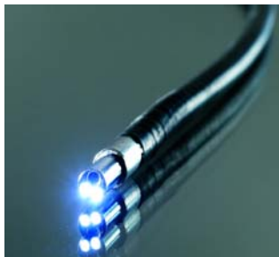
Двойной LED для подсветки на наконечнике зонда
