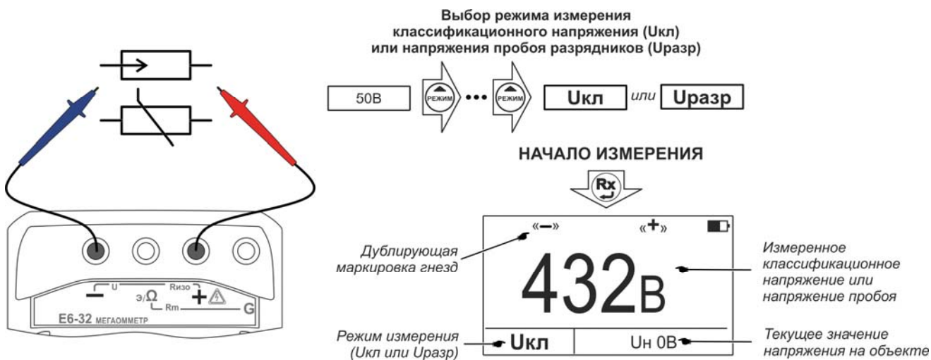
Рисунок 2.10 – Измерение классификационного напряжения или напряжения пробоя разрядников
