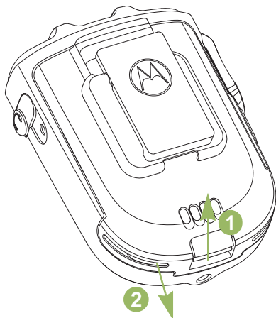
Figure 2.3 : Retrait de la batterie du WRSM
