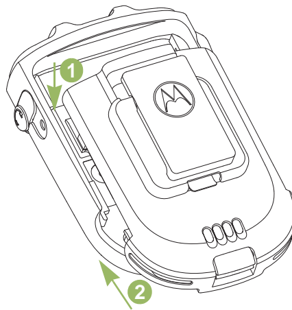
Figura 2.2: Inserimento della batteria nel WRSM
