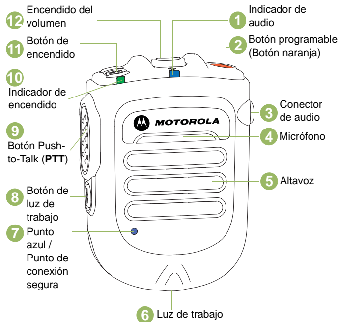
Figura 2.7: Descripción general del micrófono remoto para altavoz inalámbrico
