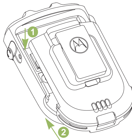
Figura 2.2: Colocar a bateria no WRSM
