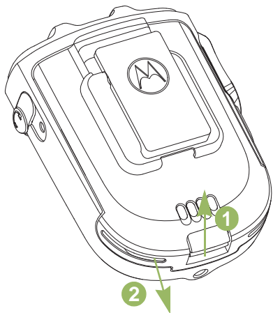
Figura 2.3: Extracción de la batería del WRSM
