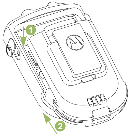
Рис. 2.2. Установка аккумулятора WRSМ
