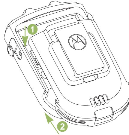
Figure 2.2: Fixation de la batterie au WRSM
