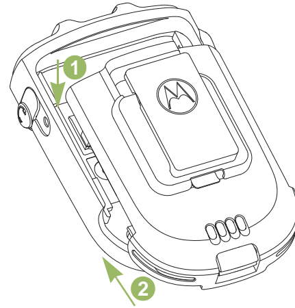
Afbeelding 2.2: De batterij in de WRSM plaatsen
