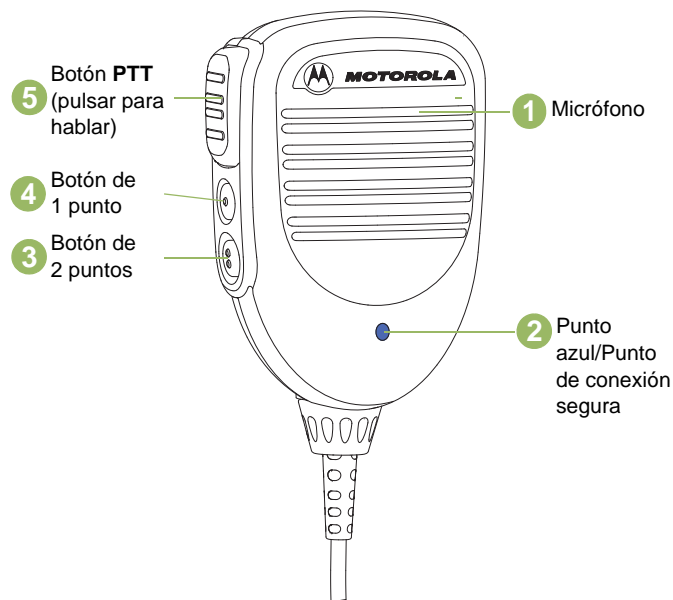
Figura 3.2: Descripción general del gateway del micrófono móvil
