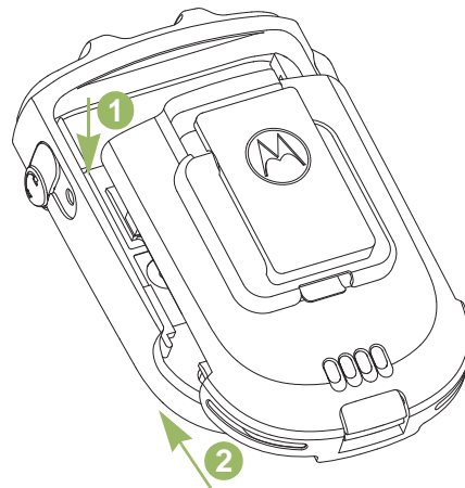
Figure 2.2 : Placement de la batterie dans le WRSM
