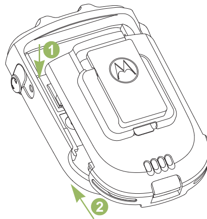
Figura 2.2: Colocación de la batería en el WRSM
