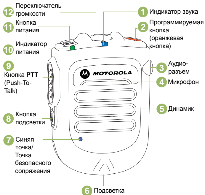
Рис. 2.7. Обзор выносного микрофона с динамиком
