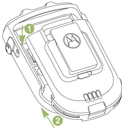
그림 2.2: WRSM에 배터리 장착
