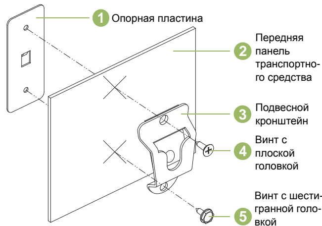
Рис. 3.1. Установка монтажного кронштейна
