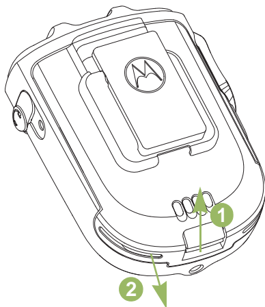
Figura 2.3: Remover a bateria do WSRM
