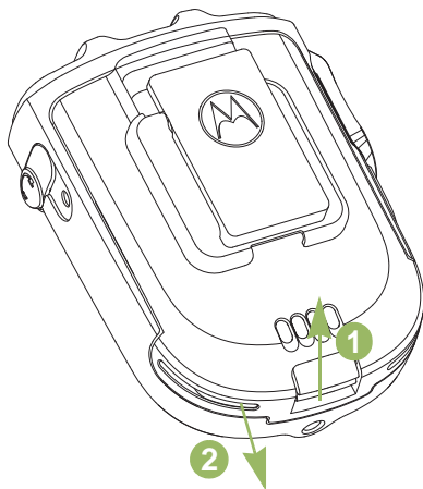
Figure 2.3: Retrait de la batterie du WRSM
