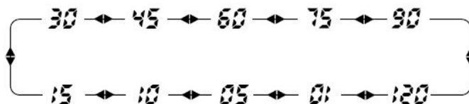
Для включения таймера нажмите клавишу «SLEEP», расположенную в верхней правой части лицевой панели приемника. Повторное нажатие приводит к изменению времени выключения согласно схеме. Выберите необходимое время выключения. Выбранное время отображается на дисплее. Через заданное время приемник выключится.
