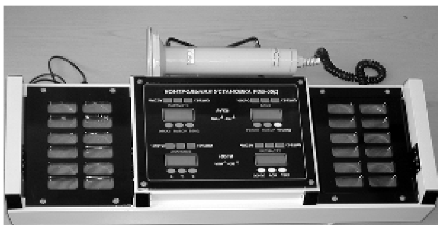
Рисунок А.2 - Установка РЗБ-05Д-03 в настольном варианте исполнения с выносным блоком детектирования БДЗА-96 загрязненности альфа-активными веществами
