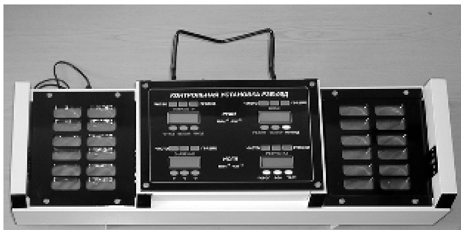
Рисунок А.4 – Установка РЗБ-05Д-04 в настольном варианте исполнения без выносного блока детектирования БДЗА-96 загрязненности альфа-активными веществами
